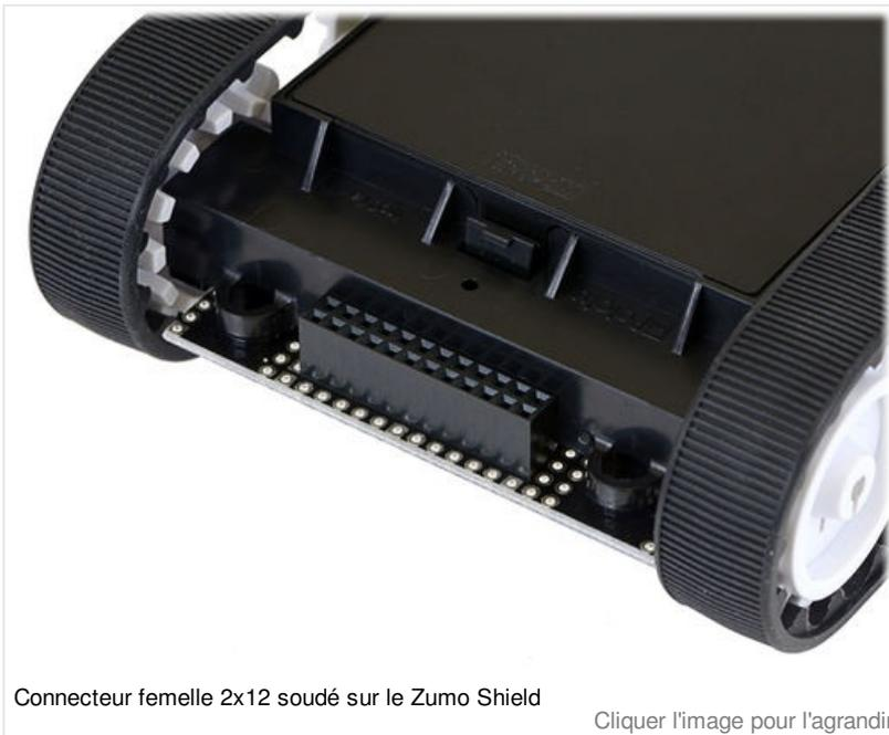
Connecteur femelle 2x12 soudé sur le Zumo Shield
