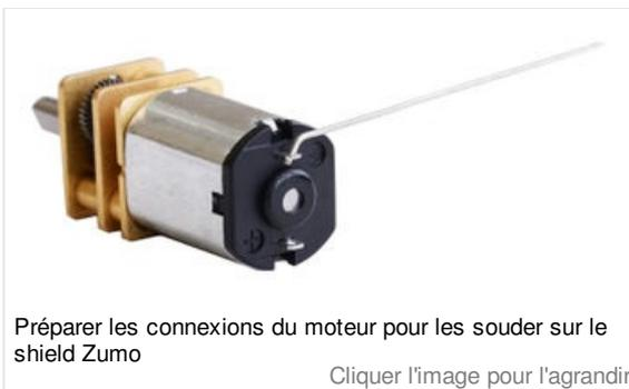
Préparer les connexions du moteur pour les souder sur le shield Zumo
