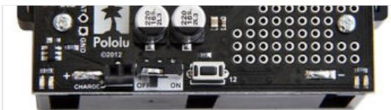
Les connecteurs des piles soudés sur le shield
