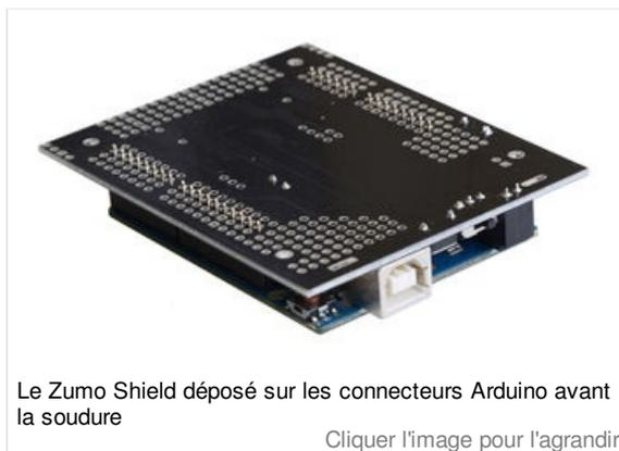
Le Zumo Shield déposé sur les connecteurs Arduino avant la soudure
